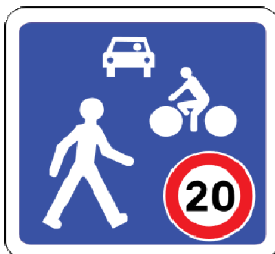
Entrée d'une zone de rencontre
