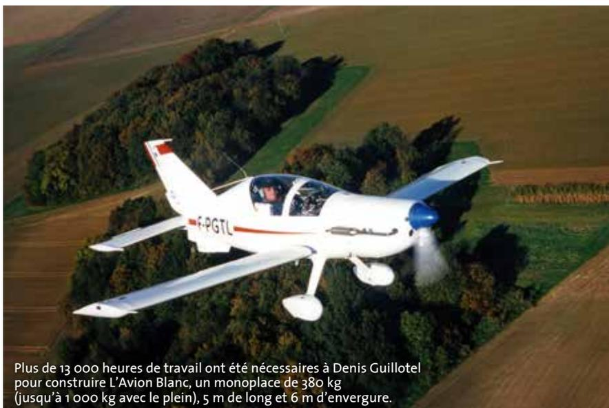
Plus de 13 000 heures de travail ont été nécessaires à Denis Guillotel pour construire L'Avion Blanc, un monoplace de 380 kg (jusqu'à 1 000 kg avec le plein), 5 m de long et 6 m d'envergure.
