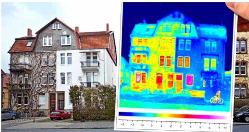
Les caméras thermiques permettent de localiser les déperditions de chaleur.
